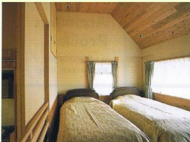
道路斜線の関係で天井が斜めに。
