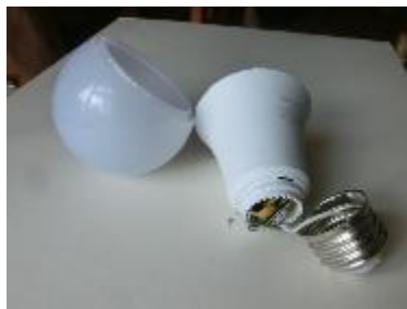
口金の取り付け部の奥に基盤
